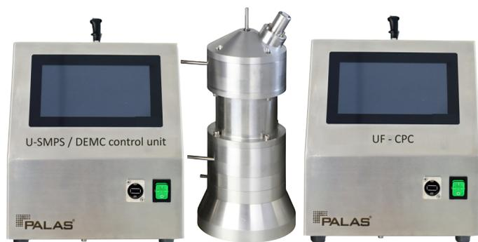
Die X-Version hat eine weiche Röntgenstrahlquelle als Neutralisierer eingebaut. Gegenüber einer radioaktiven Neutralisierung (z. B. mit Kr-85) hat dies den Vorteil, dass beim Transport des Geräts keine Auflagen zu beachten sind.
