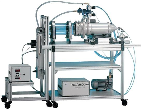
Der Filterhalter MMTC 2000 E ist in dieser Version aus V2A hergestellt, um einen höheren Temperaturbereich abzudecken.
