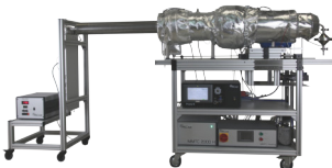
MMTC 2000 EH Edelstahlversion mit Heizung und Isolierung für Temperaturen bis 250 °C
