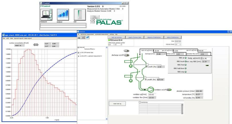
Die FTControl Software dient der zuverlässigen und wirtschaftlichen Durchführung von Filterprüfungen und Fraktionsabscheidegradmessungen mit dem welas® digital und dem Promo® optischen Aerosolspektrometer.
