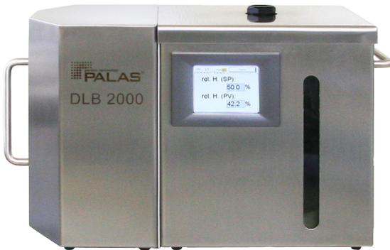
Der in der Praxis etablierte Luftkonditionierer DLB 2000 gewährleistet die vollautomatische Regelung der rel. Luftfeuchte mit höchster Stabilität. Die Eingabe der gewünschten rel. Luftfeuchte und Einstellung der Temperatur erfolgt einfach über ein Touchscreen Display.
