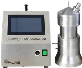
Die X-Version hat eine weiche Röntgenstrahlquelle als Neutralisierer eingebaut. Gegenüber einer radioaktiven Neutralisierung (z. B. mit Kr-85) hat dies den Vorteil, dass beim Transport des Geräts keine Auflagen zu beachten sind.
