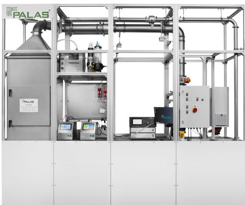
Der FET 600 ermöglicht die Prüfung von Filterelementen bis zu 610 • 610 mm. So können Filter, wie Lüftungs-, HEPA/ULPA-, Staubsaugerend-, KFZ-Innenraumfilter bewertet werden. Ausgelegt auf eine optimale Strömungsführung kann der Kanal für kleinere Filterelemente mittels Adapter verwendet werden.
